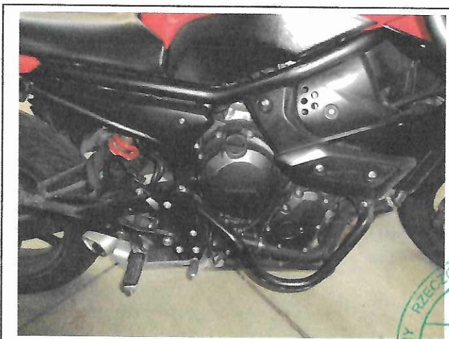
Fot.9. Zarysowania orurowania
