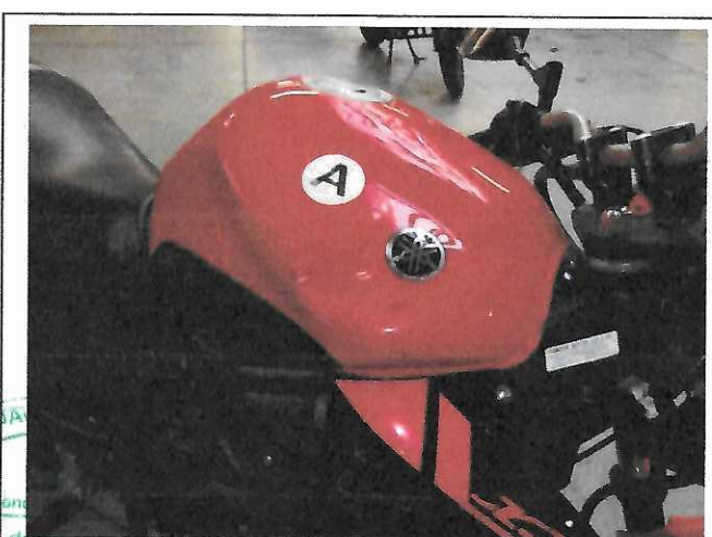
Fot.10. Wgnieciony zbiornik paliwa
