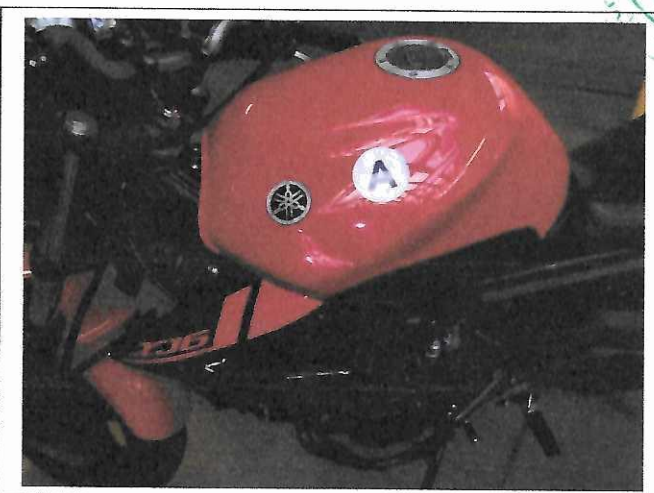
Fot 11. Wgnieciony zbiornik paliwa
