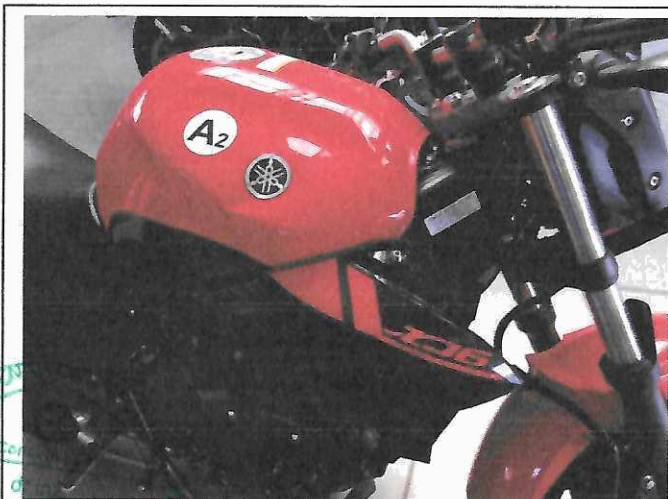
Fot.10. Wgnieciony zbiornik paliwa
