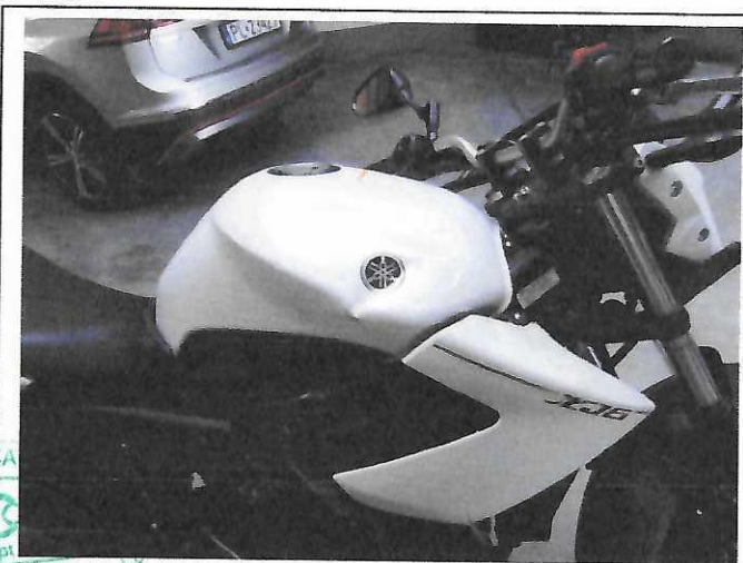
Fot.10. Wgnieciony zbiornik paliwa
